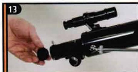
13 Снимите защитную крышку с окулярного узла.
