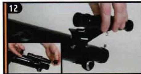
12 Установите крепление искателя на шпильки и закрепите его гайками. Снимите защитные колпачки с объектива и окуляра искателя.
