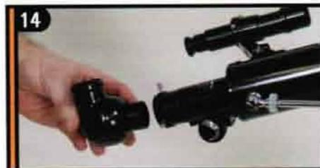
14 Вставьте посадочную втулку диагональной призмы в окулярный адаптер фокусирующего узла телескопа. Затяните фиксирующие винты.
