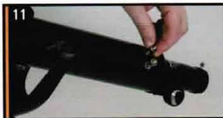
11 Снимите гайки с насечкой со шпилек, расположенных на трубе возле фокусирующего узла.
