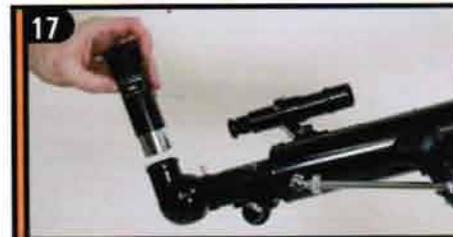
17 Вы можете изменять увеличение вашего телескопа при помощи сменных окуляров или линзы Барлоу. Установите в диагональную призму линзу Барлоу и закрепите ее винтом фиксатором.
