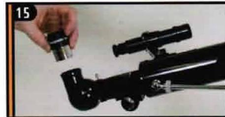
15 Установите посадочную хромированную втулку окуляра в отверстие диагонали и закрепите винтом-фиксатором
