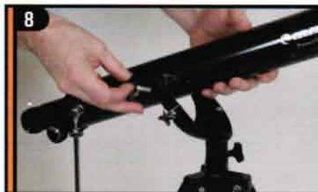
Ослабьте винт блокировки по высоте, чтобы он не выступал внутрь отверстия.
