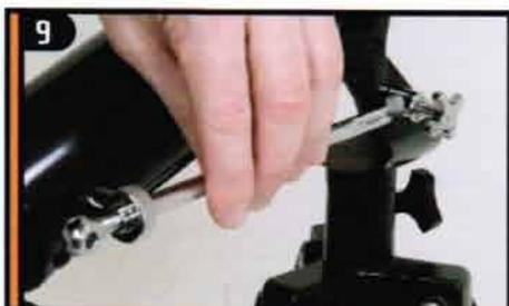
Вставьте рычаг механизма тонкой настройки по высоте в отверстие и затините винт блокировки по высоте.
