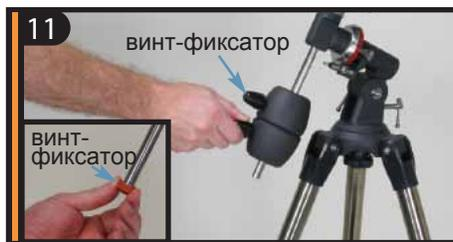
Отвинтите винт-фиксатор с торца штанги противовеса. Установите два противовеса на штангу и зафиксируйте их винтом. Закрутите обратно фиксатор штанги противовеса.
