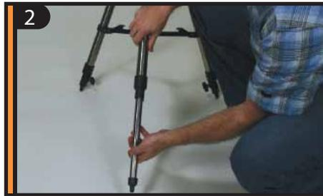
Опоры штатива выдвигаются на желаемую длину, регулируя высоту монтировки. Минимальная высота штатива - 61 см, максимальная - 104 см. Ослабьте зажим фиксатора на каждой опоре, выдвиньте опоры штатива на желаемую высоту.
