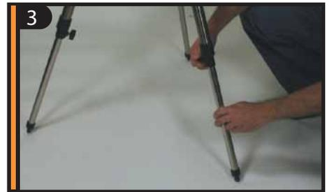
Для фиксации штатива по высоте затяните фиксаторы, расположенные на каждой опоре.
