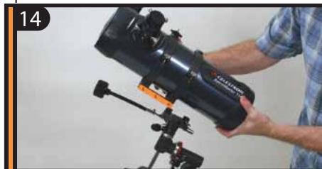
Установите трубу на экваториальную монтировку. Для этого вставьте пластину "ласточкин хвост" в открытую часть паза разъема на монтировке.
