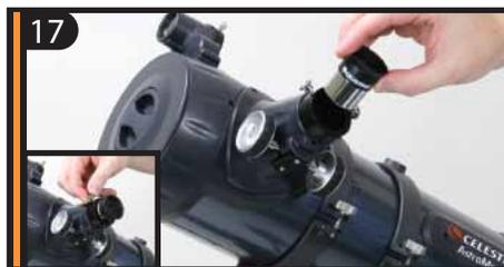
Вставьте хромированную посадочную втулку окуляра в трубку фокусировочного узла и закрепите окуляр винтом-фиксатором.
