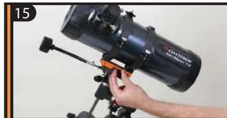
Поместите пластину посередине крепления. Зафиксируйте ее с помощью главного и предохранительного винтов крепления, закрутив их до упора.
