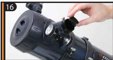
Ослабьте винты-фиксаторы окулярного узла и снимите крышку.
