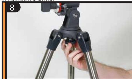
Рукой закрутите винт под головкой штатива в резьбовое отверстие внизу монтировки. Закрутите винт до упора.
