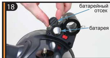
Откройте с помощью отвертки крышку отсека батареи. Установите батарею символом "+" наружу.
